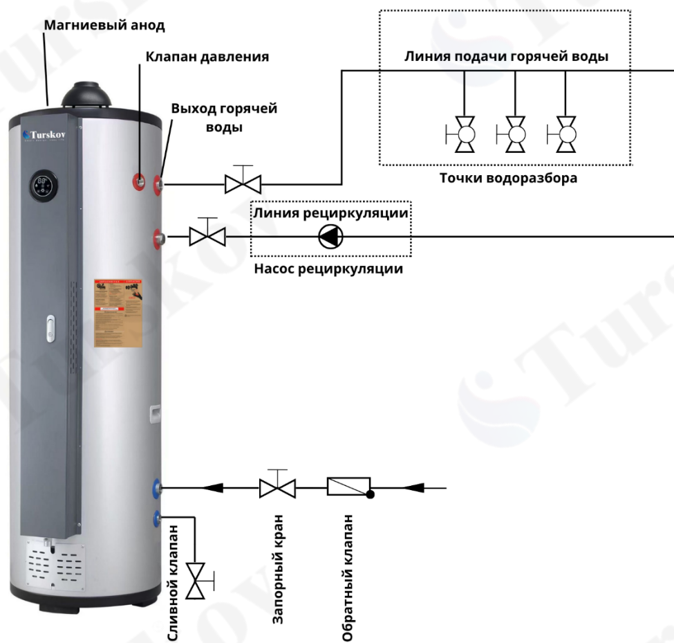
Схема 2. Подключение к сети водоснабжения.
